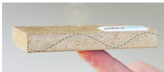
Abb. 3: Probe mit einer 2-D-wellenähnlichen Dichtestruktur im Inneren
