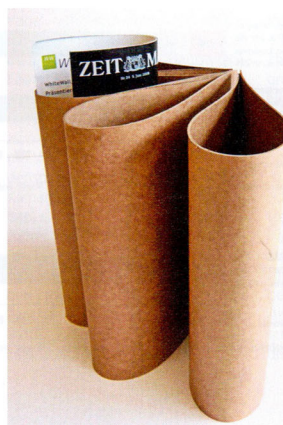
Holzblech: Das vielseitige Material besteht aus Holzfasern, vereint jedoch Eigenschaften von Blechen, Verbund- und Kunststoffen
